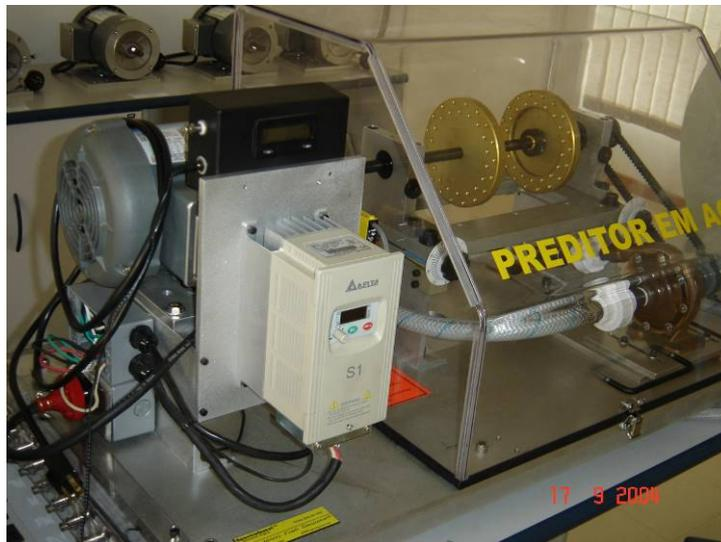
Figura 1: Simulador de falhas em MIT.
